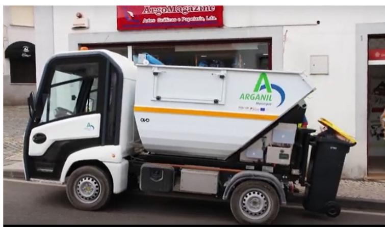
**Figura 12** Veículo elétrico de 1m<sup>3</sup> afeto à recolha porta-a-porta de resíduos valorizáveis
