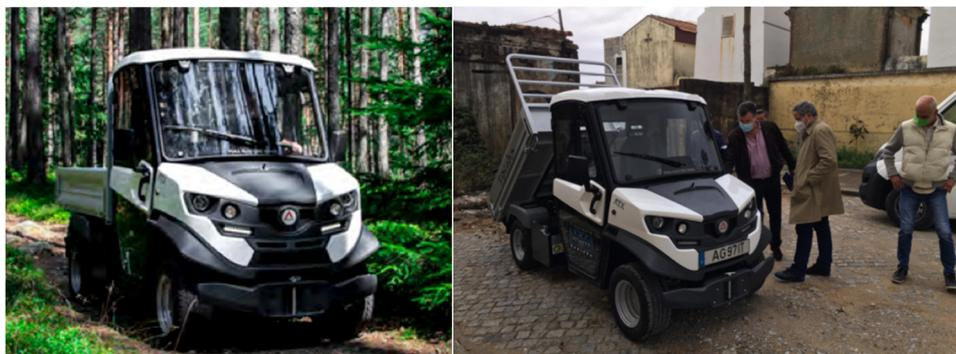
**Figura 19** Viatura que foi considerada no cenário 1 para as ações de acompanhamento e monitorização da compostagem comunitária. Alké, modelo ATX 340E com autonomia de 150 km (elétrico)
