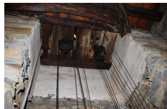
Figura 27 - Polias da máquina do relógio
